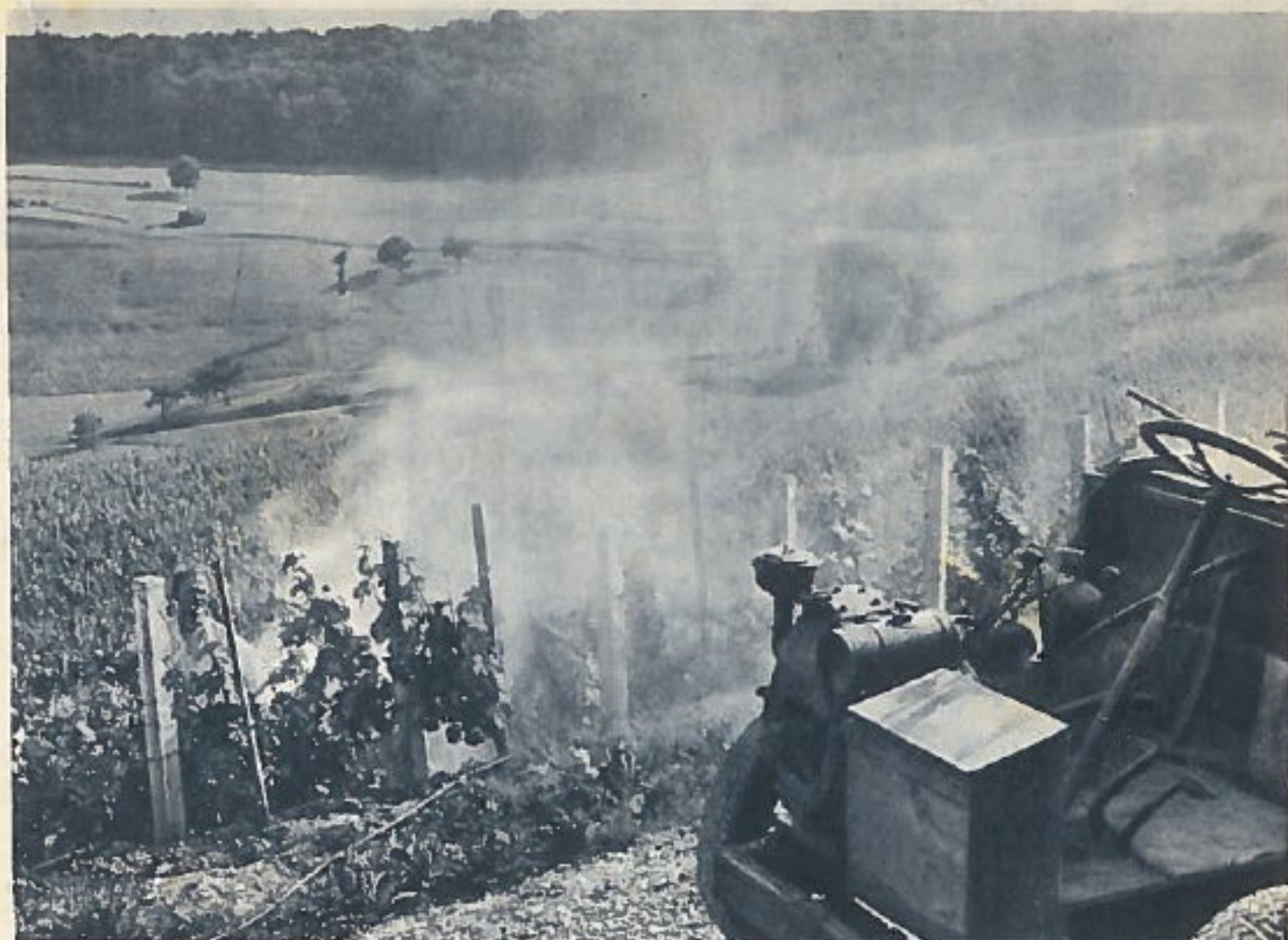
Nebenspritzung. Selbstgebautes Auto mit Motorspritze und Flüssigkeitsbehälter. Antrieb des Wagens durch Pumpenmotor. Einbau einer alten Wasseruhr zur Feststellung des Spritzbrühverbrauchs.
